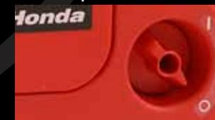
L'interrupteur On/Off sur EPSi1000 **arrête le moteur** en même temps qu'il **coupe le carburant**, ce qui assure que l'essence **ne peut pas s'infiltrer** dans le carter d'huile du moteur.
