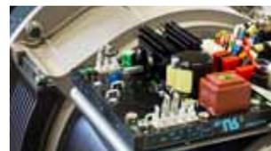
AVR réfère à **Automatic Voltage Regulator** (régulateur automatique de voltage) et maintient une **tension constante et stable**. Il en résulte de meilleures performances pour appareils sensibles.
