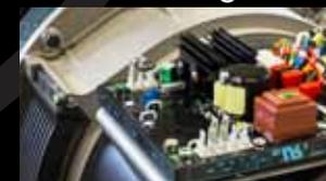
AVR réfère à **Automatic Voltage Regulator** et maintient une **tension constante et stable**. Il en résulte de meilleures performances pour les appareils sensibles.
