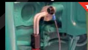
Plusieurs **dispositifs de préchauffage** sont offerts en option, comme le préchauffage de l'eau de refroidissement, le préchauffage du carter d'huile et celui de l'air d'admission. Ces options / accessoires permettent à l'utilisateur de **démarrer** le moteur dans des **conditions de froid extrême**.
