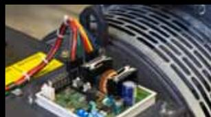
AVR signifie **Automatic Voltage Regulator** et maintient une **tension constante et stable**. Il en résulte de meilleures performances pour appareils sensibles.
