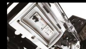
Le contrôle d'isolement est une des deux possibilités qui garantissent une protection efficace de l'utilisateur. La protection différentielle offre une deuxième possibilité. Celle-ci fonctionne en général avec un piquet de terre, parfois difficile à installer ou à enlever.
