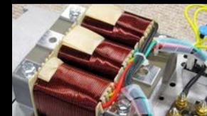
Ein Standard 400V Drehstromgenerator kann 1/3 seiner Leistung als Wechselstrom pro Phase liefern. Auf EP6500T(E)-25 und auf EP6500TLN Stromerzeugern ist eine der Wicklungen verstärkt ausgeführt, was dem Benutzer ermöglicht, die Wechselstromsteckdose bis zu max. 4kVA zu belasten.
