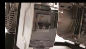
Optional können unsere Stromerzeuger mit diesem Schutz ausgestattet werden. Bei Überbelastung schaltet die thermisch-magnetische Sicherung aus, sodass sowohl der Generator als auch das angeschlossene Gerät gesichert bleiben. Auch Kurzschluss wird durch diese Option detektiert.
